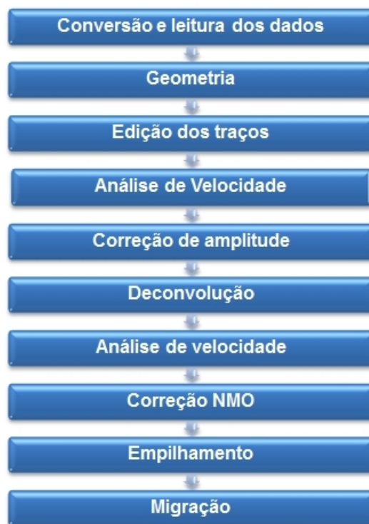
Figura 4.2 – Fluxograma mostrando a sequência básica do processamento sísmico.
