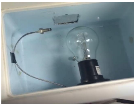
Figura 22: Interior da Câmara térmica, onde se encontram a lâmpada incandescente e o sensor de temperatura termopar MAX6675
