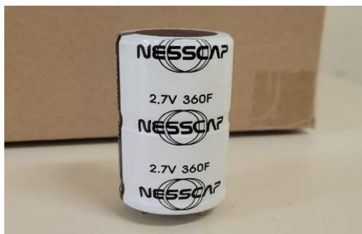
Figura 19: Supercapacitor utilizado em circuito de bancada.
