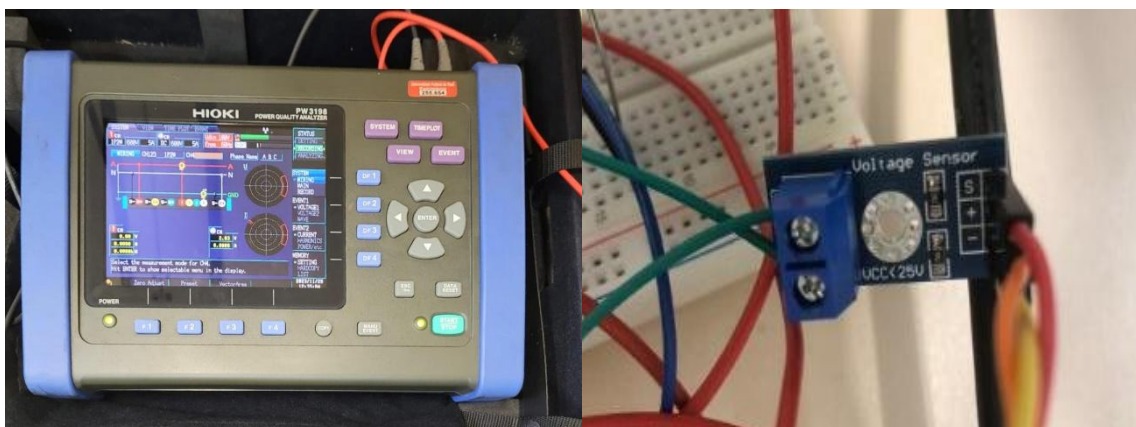
Figura 23: Dispositivos de medição de tensão. A) Analisador de qualidade de energia HIOKI. B) Sensor de Tensão
