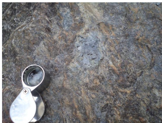
Fotos 19 e 20: A primeira foto mostra afloramento de Grafita-quartzo xisto referente ao ponto GH-31 e a segunda ilustra o Muscovita-biotita xisto, laje do córrego Palmeira.
