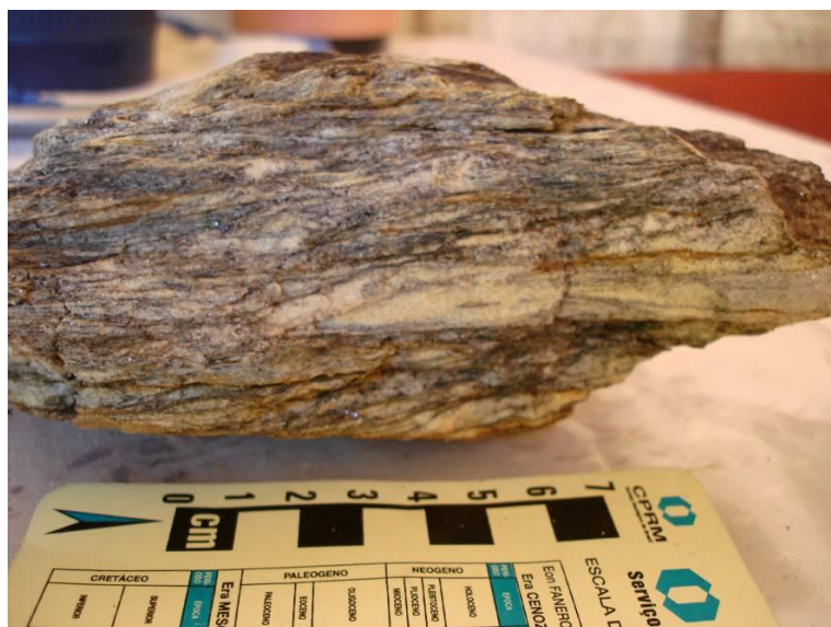
Foto 22: Amostra de mão de Quartzo micaxisto, fresco a pouco alterado T-139.
