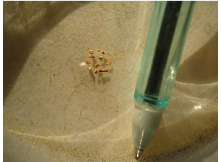
Fotos 15 e 16: Cristais de rutilo metálico centimétricos encontrados nos aluviões. Sua forma prismática indica proximidade da área-fonte. Pintas de ouro encontrados nos concentrados.
