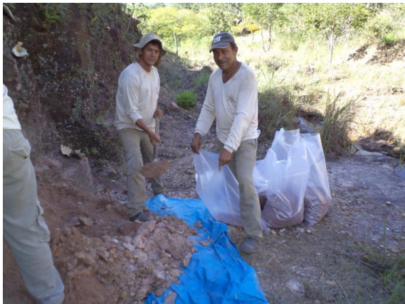
Fotos 10, 11 e 12: Coleta de amostragem volumétrica para análise do xisto do paredão do Dedé (trincheira T105-A1). Após a pesagem inicia-se o procedimento de homogeneização, quartejamento e concentrado final do material coletado.
