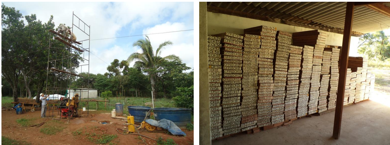
Fotos 17 e 18: equipamento de sondagem utilizado e caixas de testemunhos armazenadas no equipamento.
