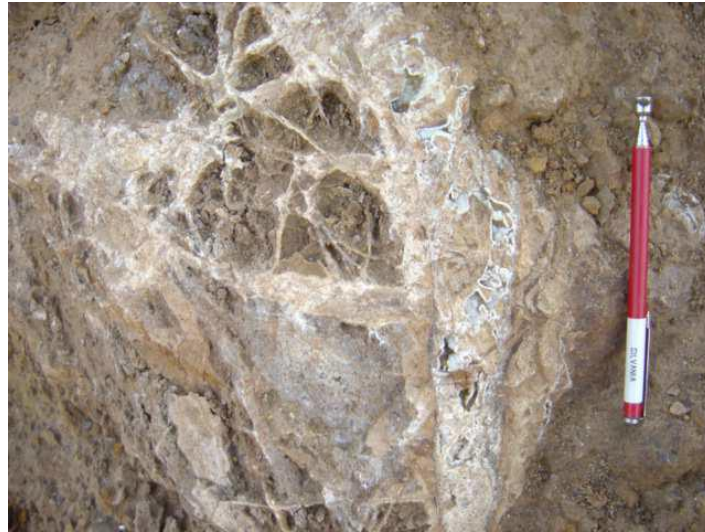
Figura 10- Foto de detalhe de um bloco de cimentado apatítico mostrando estrutura alveolar
