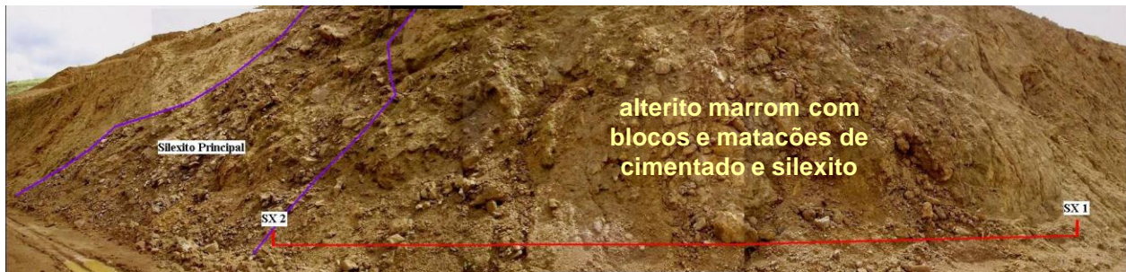
Figura 18- Frente de silexito amostradas para testes em bancadas.
