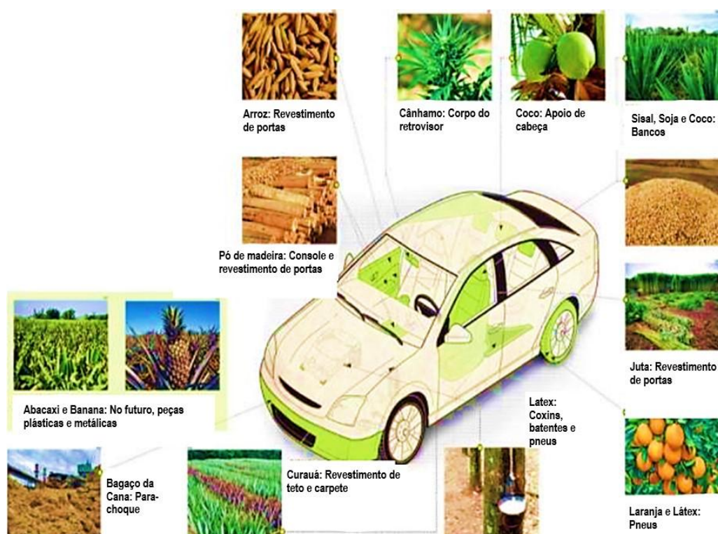
Figura 4 - Compósitos de fibras naturais utilizados em automóveis.
