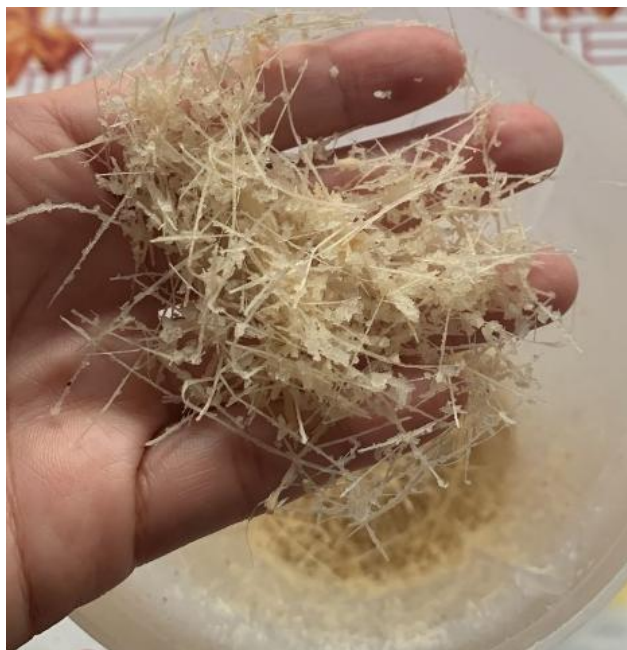
Figura 20 - Fibras da polpa do bagaço de cana-de-açúcar após serem trituradas pelo liquidificador.
