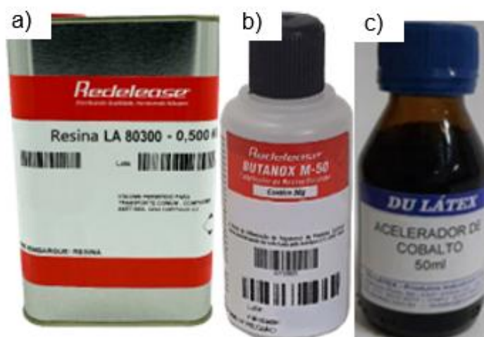
Figura 17 - Imagem ilustrativa a) resina poliéster ortoftálica, b) acelerador e c) iniciador.
