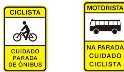
Figura 44 - Sinalização vertical para ciclofaixas compartilhadas com ônibus
