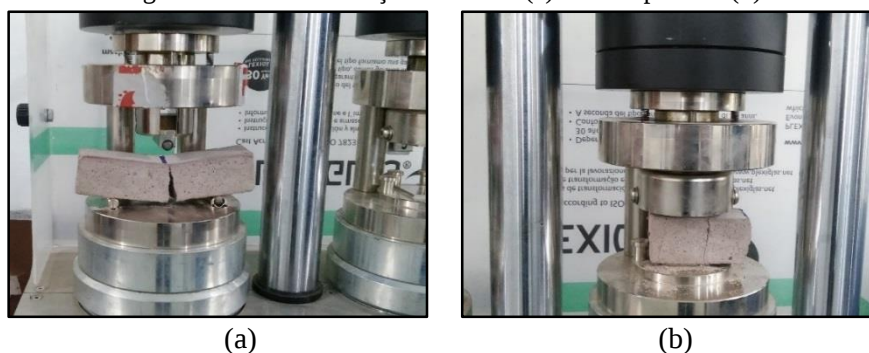
Figura 33 – Ensaio à tração na flexão (a) e à compressão (b).
