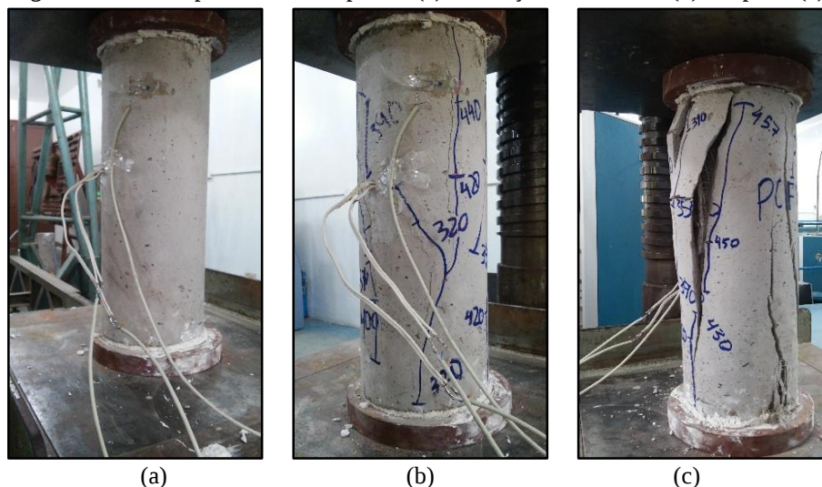
Figura 55 – PCFV posicionado na prensa (a), formação das fissuras (b) e ruptura (c).
