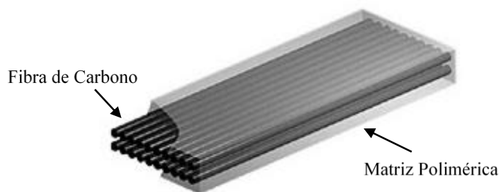
Figura 10 – Representação esquemática de um sistema composto com fibras de carbono.
