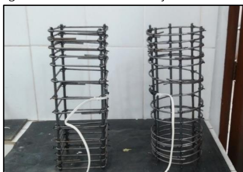
Figura 44 – Armadura do reforço instrumentada.
