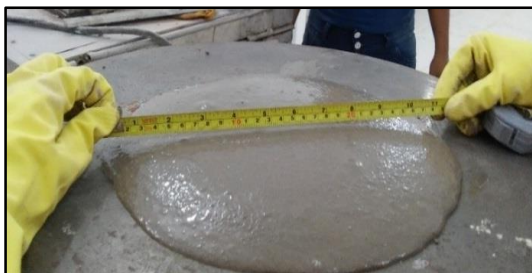
Figura 31 – Determinação do índice de consistência da argamassa.
