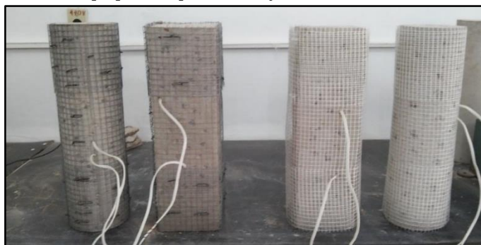
Figura 45 – Modelos preparados para o reforço com tela soldada e de fibra de vidro.
