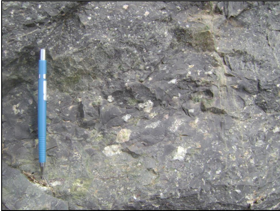
Figura 5 – Conglomerado sedimentar com clastos de até 20 mm imersos em uma matriz muito fina. À direita, destaque para diversas fraturas paralelas preenchidas por minerais de cor verde oliva que também estão disseminados na matriz (2008-TEC-01).
