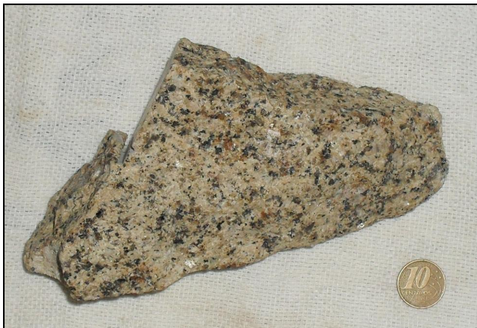
Figura 12 – Aspecto macroscópico do Granito Meruoca coletado na pedreira do ponto 2008-TEC-02.
